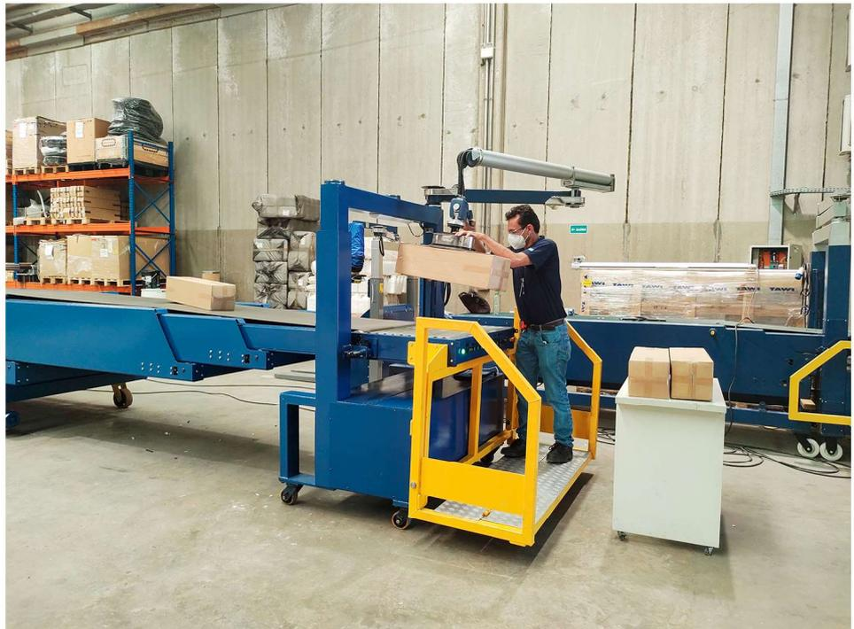
A este formato da esteira são adicionados a torre telescópica, o manipulador a vácuo e uma plataforma elevatória para o operador manipular materiais em alturas elevadas. Além disso, recebe ainda um compartimento para acomodar a bomba a vácuo e os comandos de movimentação da torre para cima/para baixo e habilitar/ligar/desligar a bomba a vácuo no painel de comando.
