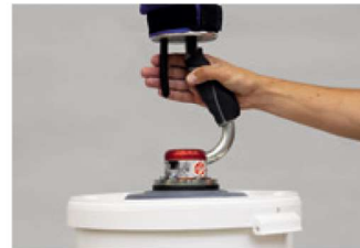
Unidade de controle com função de liberação rápida: pega - sobe - desce - solta.
